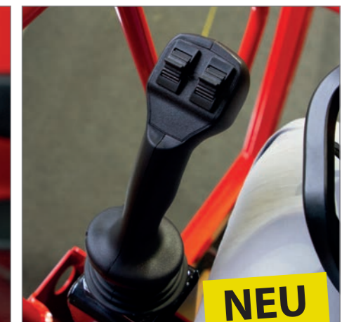
3-Kreis Joysticksteuerung hydr. oder elektrisch
